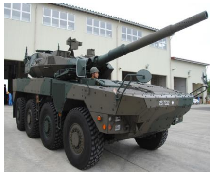
105mm砲を搭載した陸上自衛隊の16式機動戦闘車(MCV)
